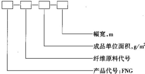
示例:聚丙烯长丝纺粘针刺非织造土工布,单位面积质量 450g/m<sup>2</sup>,幅宽 4.5m,其型号为:FNG-PP-
