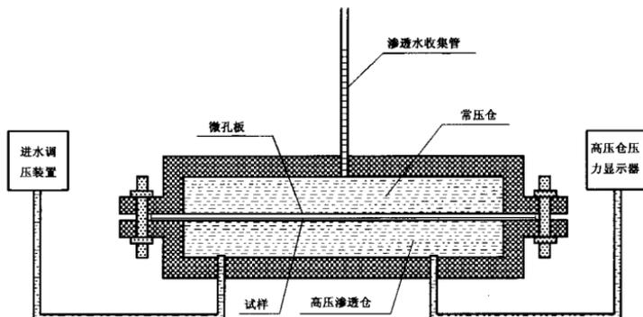
图 1 渗透性测定装置示意图
